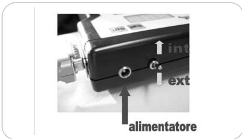
2. Collegare il ricevitore al programmatore PRG\_01 per mezzo del cavo in dotazione (connettore a 6 poli). Il ricevitore radio esterno dovrà essere alimentato e quindi scollegare l'alimentare esterno
