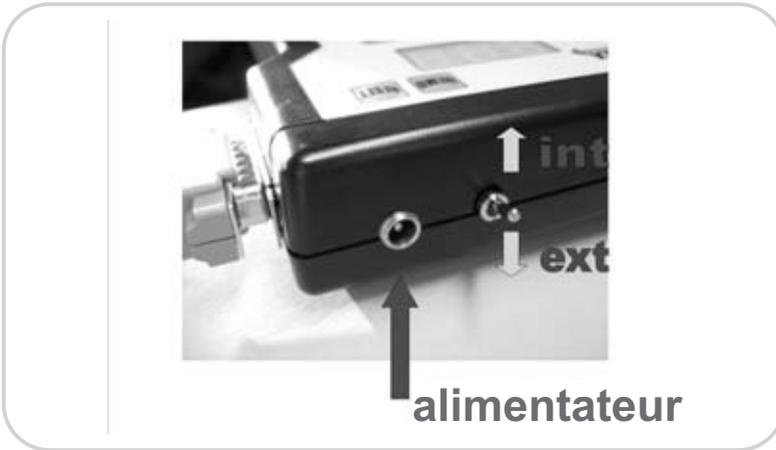
2. Connecter le récepteur au programmeur PRG\_01 par le câble en dotation (connecteur à 6 pôles). Le récepteur radio extérieur devra être alimenté et donc déconnecter l'alimentateur extérieur
