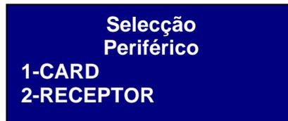
Seleccionar a entrada pretendida utilizando as teclas ▲ ▼ e confirmar com **Enter**.
