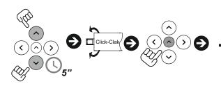
Azione mantenuta: ad ogni pressione di un tasto (salita o discesa) il motore si muoverà per 1 sec. Tenendo premuto il tasto per più di 2 secondi il motore si muove in modalità automatica
