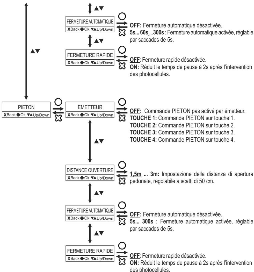
La logique de fonctionnement de la commande piéton est AUTOMATIQUE et ne peut pas être modifiée.
