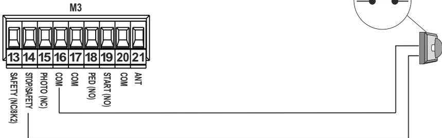
**ENLACEMENT STOP 8K2 / CONEXION 8K2 STOP**
