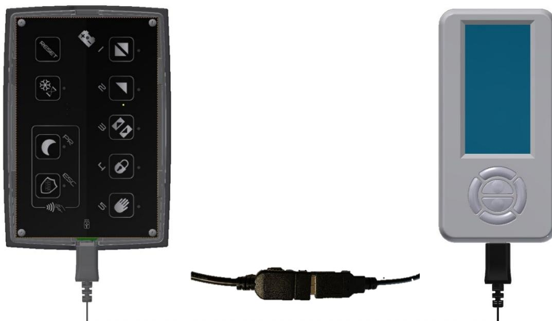
La porta micro-usb è ad uso esclusivo per il collegamento, mediante cavi commerciali non forniti, del Digidor oppure Digidor T oppure Digidor BT (**ESCLUSA FUNZIONE BLUETHOOT – NON FUNZIONANTE**). Una volta collegato il Digidor sarà funzionante ed utilizzabile (per funzionalità vedi manuale Digidor).
