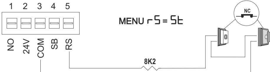
**17 Collegamento LAMPEGGIANTE / FLASHING LIGHT connection**
