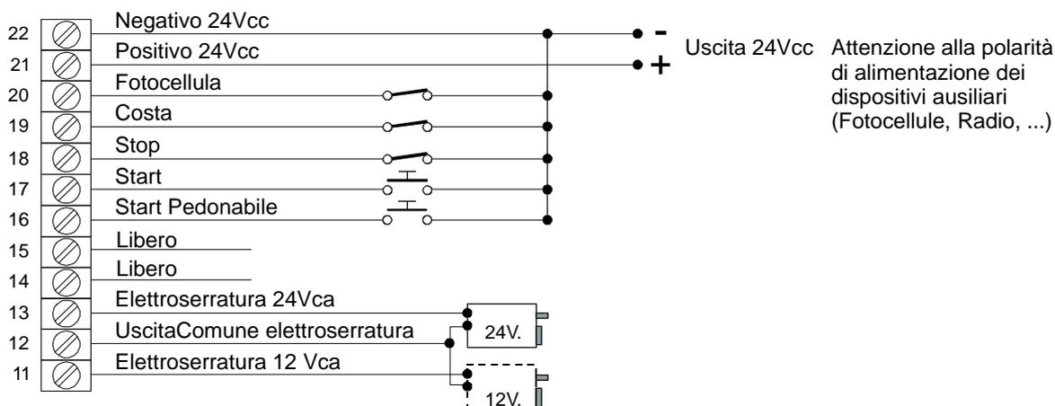
Esempio di collegamento di 2 elettroserrature 12V in serie
