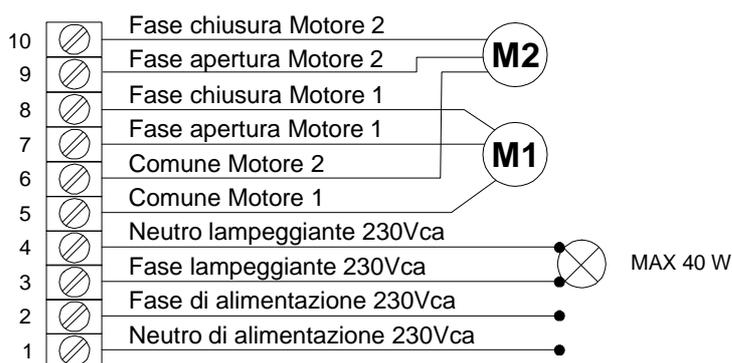
**N.B.** Per l'utilizzo di questa apparecchiatura con finecorsa non predisposti di connettore a 10 poli ISEO si deve utilizzare l'interfaccia codice AAP103.
