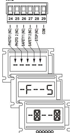
Les contacts de la borne M8 sont multifonction et peuvent être programmés avec les menus C40-C41-C42-C43-C44, dans la notice ils seront identifiés avec le nom de sa fonction de défaut ou primaire.
