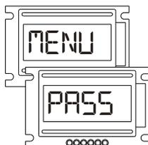
Quand l'appareil est au repos, appuyer par 3 secondes sur les touches (ESC et OK) simultanément, le message MENU apparaîtra et puis le message PASS.
