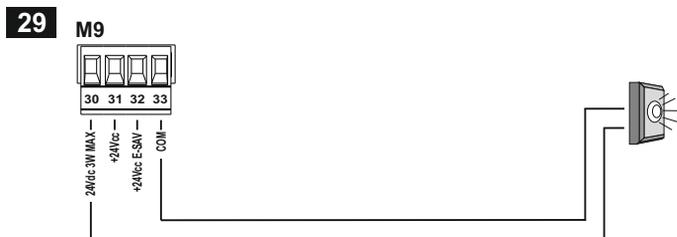
COLLEGAMENTO SENSORE GIRI MOTORE
