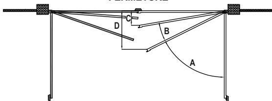
A = Marche normal avec intervention des dispositifs de sécurité et inversion du mouvement
