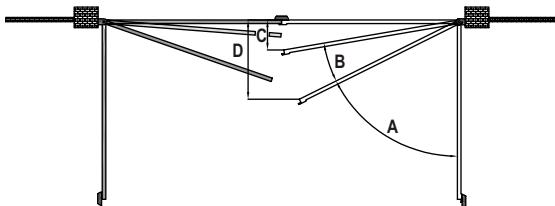
A = Κίνηση κανονική με συστήματα ασφαλείας επέμβαση και αντιστροφή της κίνησης
