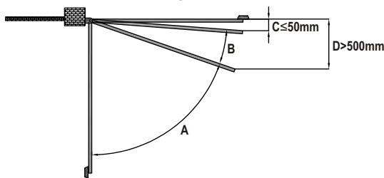
A = Marche normal avec intervention des dispositifs de sécurité et inversion du mouvement
