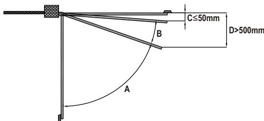
A = Κίνηση κανονική με συστήματα ασφαλείας επέμβαση και αντιστροφή της κίνησης
