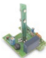
AU2750 Ersatz-LED-Platine für DSL (12-24-115-230V)
