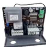
2B AS07300 Steuergerät mit Bordradio (SR302 - 868 MHz)
