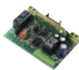
3 AU02910 Récepteur 2 CH à brochage pour centrales
