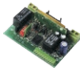
3 AU02910 Récepteur 2 CH à brochage pour centrales
