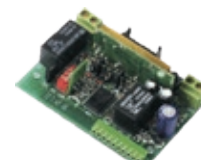
DRS 8682 2-Kanal-Steckempfängerplatine für Steuergeräte
