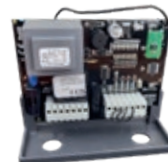
AS07200 (SR302 - 433 MHz) Steuereinheit mit Radio an Bord Siehe Seite 120
