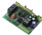
3 AU02910 Récepteur 2 CH à brochage pour centrales
