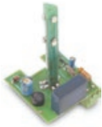
AU2750 Carte LED de remplacement pour DSL (12-24-115-230V)
