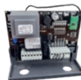
AS07200 (SR302 - 433 MHz) Centrale de commande avec radio intégrée. Voir la page 120
