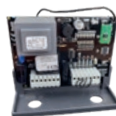
AS07300 (SR302 - 868 MHz) Centrale de commande avec radio intégrée. Voir la page 120
