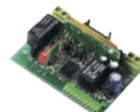
DRS 8682 Receptor 2CH enchufable para centrales
