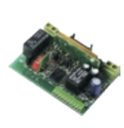
5 AU02910 Receptor 2 ch enchufable para centrales DRS4332
