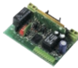
3 AU02910 Receptor 2 ch enchufable para centrales DRS4332
