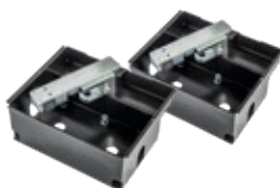
2 AJ49300 Caja de cimentación autoportante en acero con acabado en cataforesis, tapa y desbloqueo incluidos
