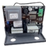
2A AS07200 Centrale di comando con radio a bordo (SR302 - 433 MHz)
