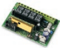
DRS 4334 Ricevente 4 canali per contenitori DRR 1000, DRR 2000 e lampeggiante DSL 2000 (uso esterno)
