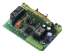
DRS 4332 Ricevente 2 canali ad innesto per apparecchiature di comando
