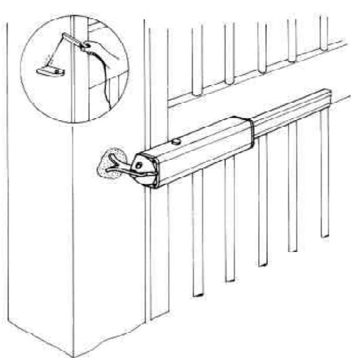
ESEMPI DI APPLICAZIONE DELLE STAFFE SU PILASTRI IN MURATURA O IN TUBOLARE METALLICO
